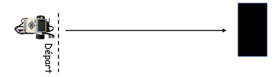
Exercice #2: Le robot doit avancer et s'arrêter au carton noir grâce au capteur de lumière. Il doit ensuite reculer de 0,5 mètre.
